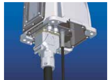
Manipulatorkabelanschluss seitlich und an der Basis (optional) des Roboters
