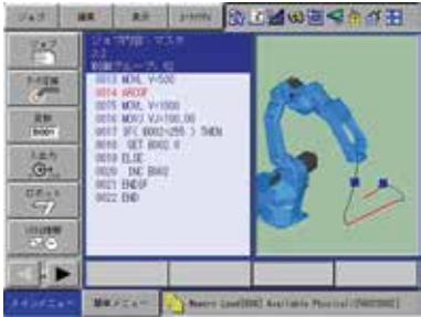
1. Visualisierung des Bewegungspfad per Machine Lock
